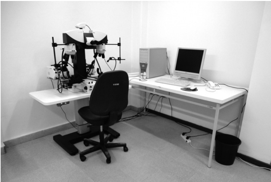
Macro comparador balístico. Área Criminalística. Dotación habitual en todos los Laboratorios Regionales y satélites.
